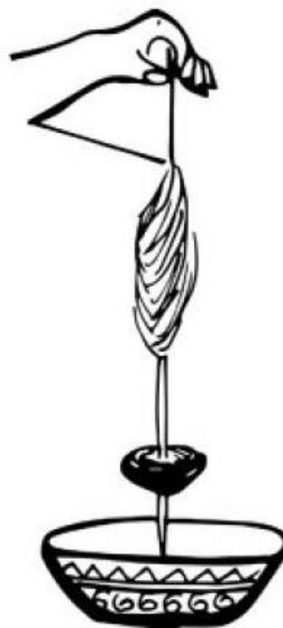
Figura 25.1 Hilatura con soporte con eje de madera y espiral de disco en un cuenco giratorio (Charney 1887). Redibujado por Kristin Sullivan.
